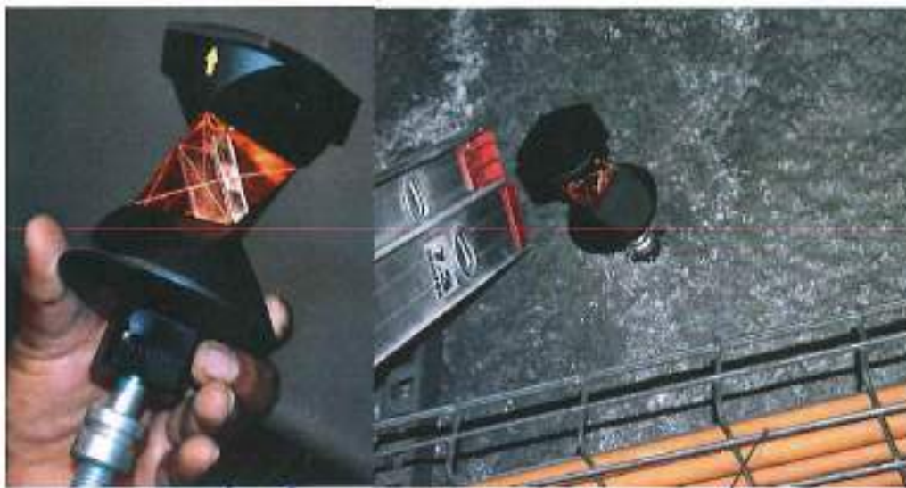
Fotografía 37. Prisma de alta precisión instalado en las estaciones de medición.
