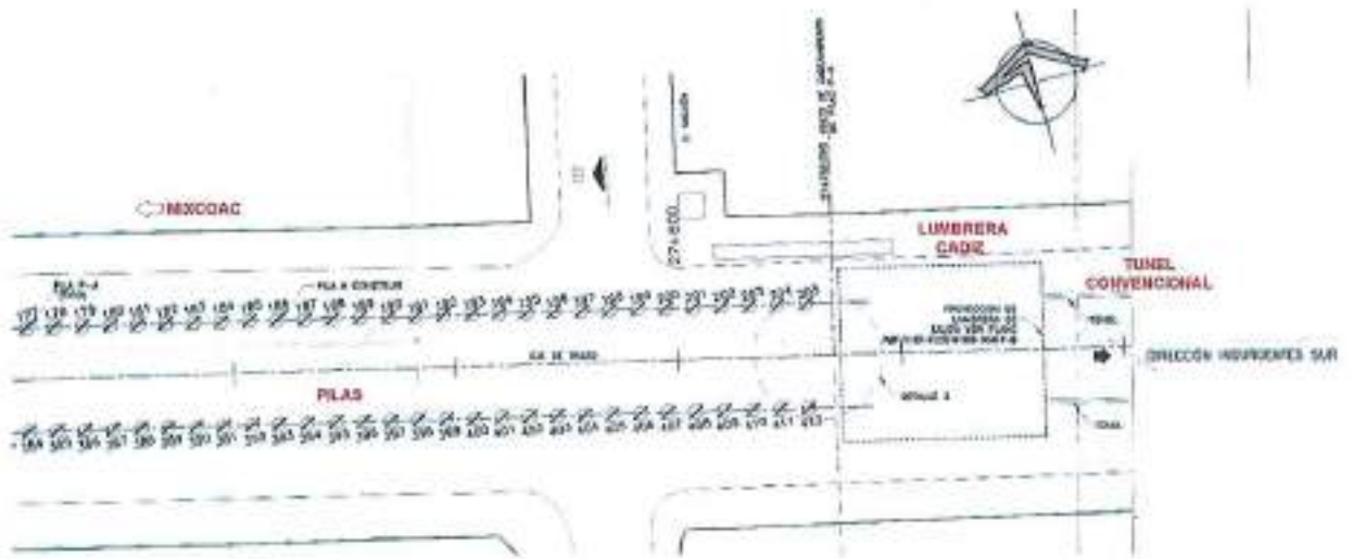
Figura 22. Planta de localización. Inicio de la zona excavada con pilas en dirección Mixcoac (imagen tomada del plano PMDF-12-EST-612295-IV-0019-34582-P-AB).
