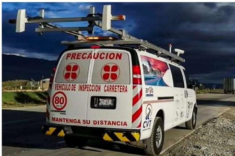
Figura 2. Vehículo certificado por iRAP para levantamiento de imágenes georreferenciadas
